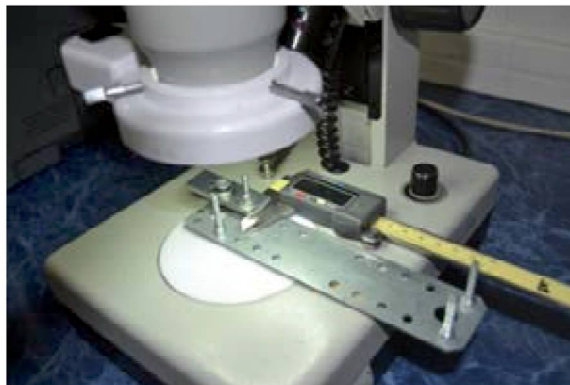
Рис. 8. Измерение ширины трасс модернизированным цифровым штангенциркулем в поле зрения оптического микроскопа
